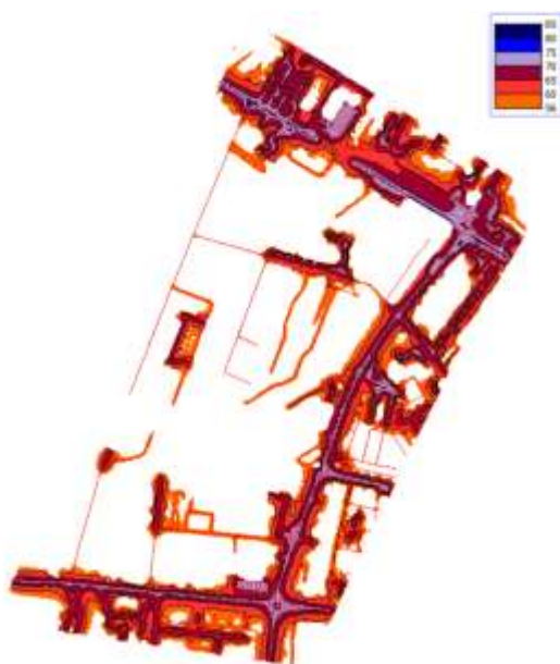
Fig.2. Zone afectate indicatorul Lden - 2021
